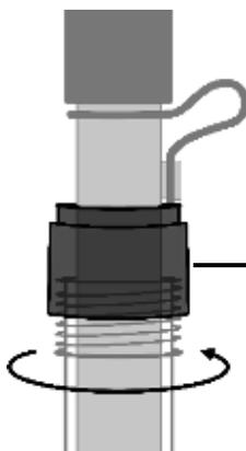
Stellen Sie vor dem Herausziehen oder Zurücksetzen der Elektrode sicher, dass der blaue Verschluss an der Flasche vollständig gelöst ist, damit sich die Elektrode reibungslos hinein- und herausbewegen kann.
