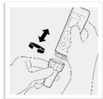
La protezione dell'elettrodo può essere rimossa rimossa per pulire l'elettrodo e riposizionata dopo la pulizia.
