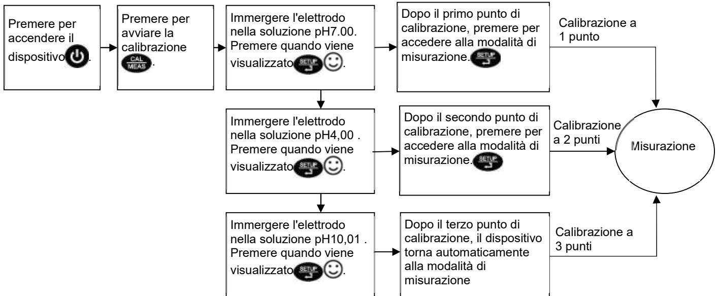
Abbildung 10 – Ablaufdiagramm Kalibrierung und Messung
