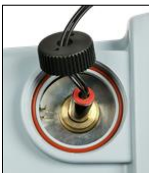
Install the new tungsten filament lamp module.
