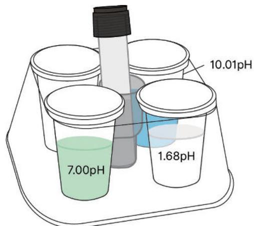
3.5 Spülen Sie die Elektrode mit reinem Wasser ab (vorzugsweise mit destilliertem oder deionisiertem Wasser, alternativ mit Umkehrosmose-Wasser), und tupfen Sie die Elektrode dann mit einem sauberen, fusselfreien Tuch trocken, um überschüssiges Wasser zu entfernen (achten Sie darauf, die Glasmembran NICHT zu reiben).
