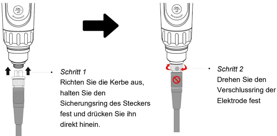
11.4 Nach dem Einbau der neuen Elektrode führen Sie bitte mindestens eine 2-Punkt-Kalibrierung durch. Wie Sie kalibrieren, erfahren Sie in Abschnitt 4.1.
